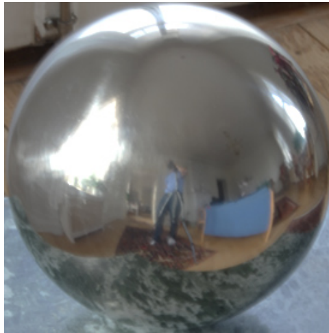
Figure 3: En lågupplöst HDR-bild (32 bitar per färgkanal) av den speglande kulan. Bilden är konverterad till 8 bitar per färgkanal för att kunna tryckas.
